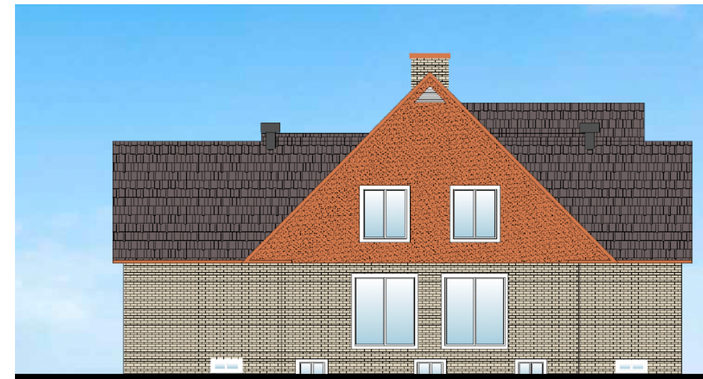
Façade latérale droite, proposant un pourcentage de maçonnerie de 52%
