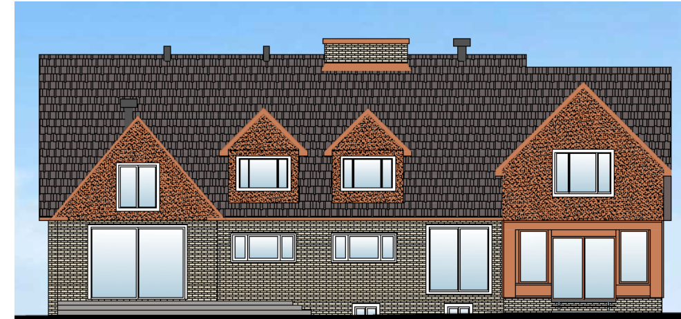
Façade arrière, proposant un pourcentage de maçonnerie de 47%
